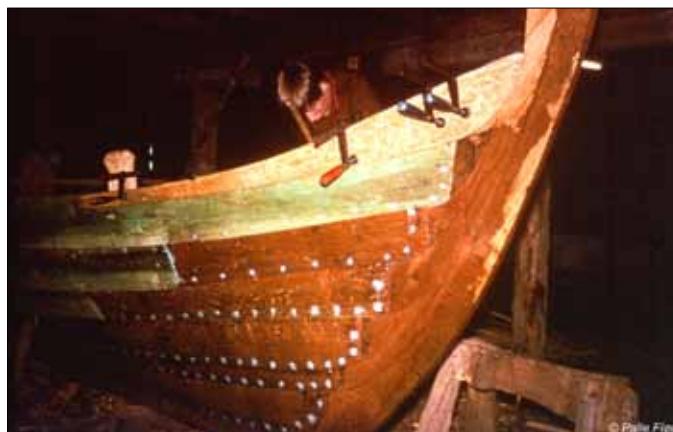
Sidste bordplanke monteres
