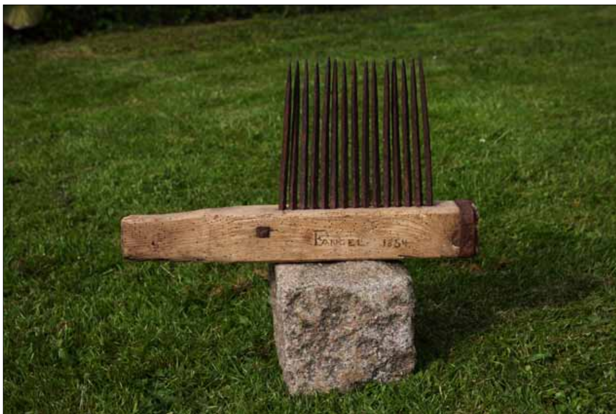
Heglen til at rede uld før spinning. Er blevet brugt ved møllen. Fremstillet af Fangel i 1854.
