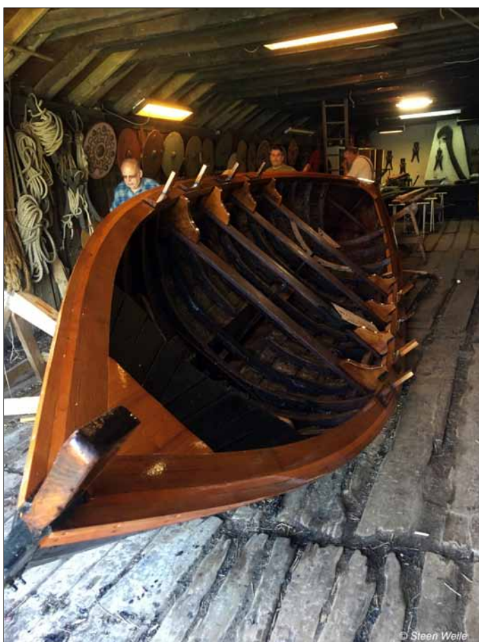
Ottar lagt på siden. Der er nogle revner der skal tættes.
