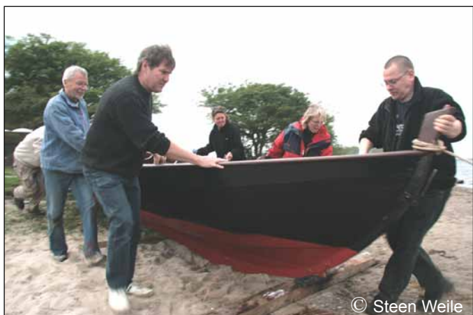
Bundmaling smøres på tidligst 24 timer før søsætning
