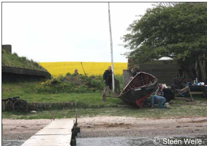
Bundmaling smøres på tidligst 24 timer før søsætning
