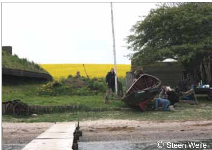
Bundmaling smøres på tidligst 24 timer før søsætning
